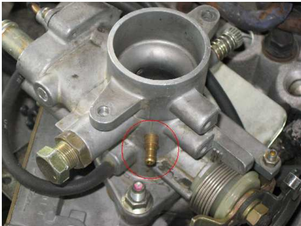
Figura 4b: Mezcladoras Aisan – Localización del Puerto de aire al vacío
